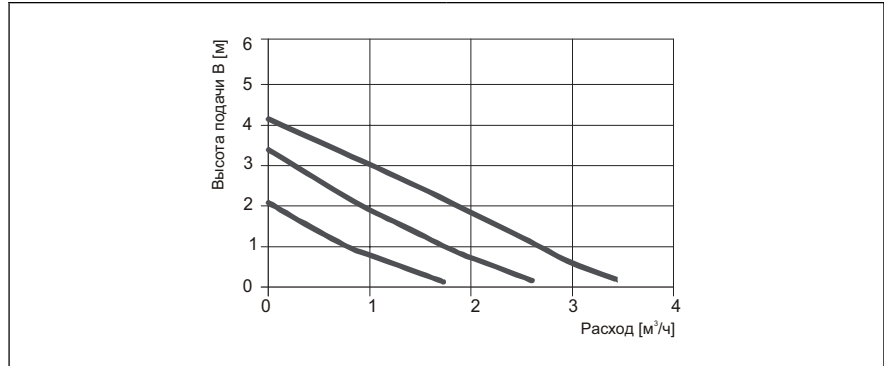
Диаграмма расхода для трехступенчатого насоса
