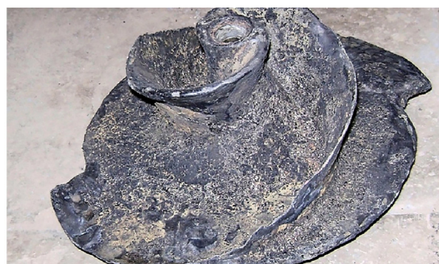
❖ Фото 6. Изношенное рабочее колесо фекального насоса Flygt
