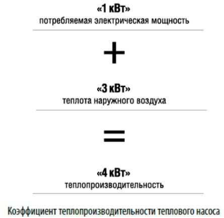
$$COP = \frac{4 \text{ кВт}}{1 \text{ кВт}} = 4$$
