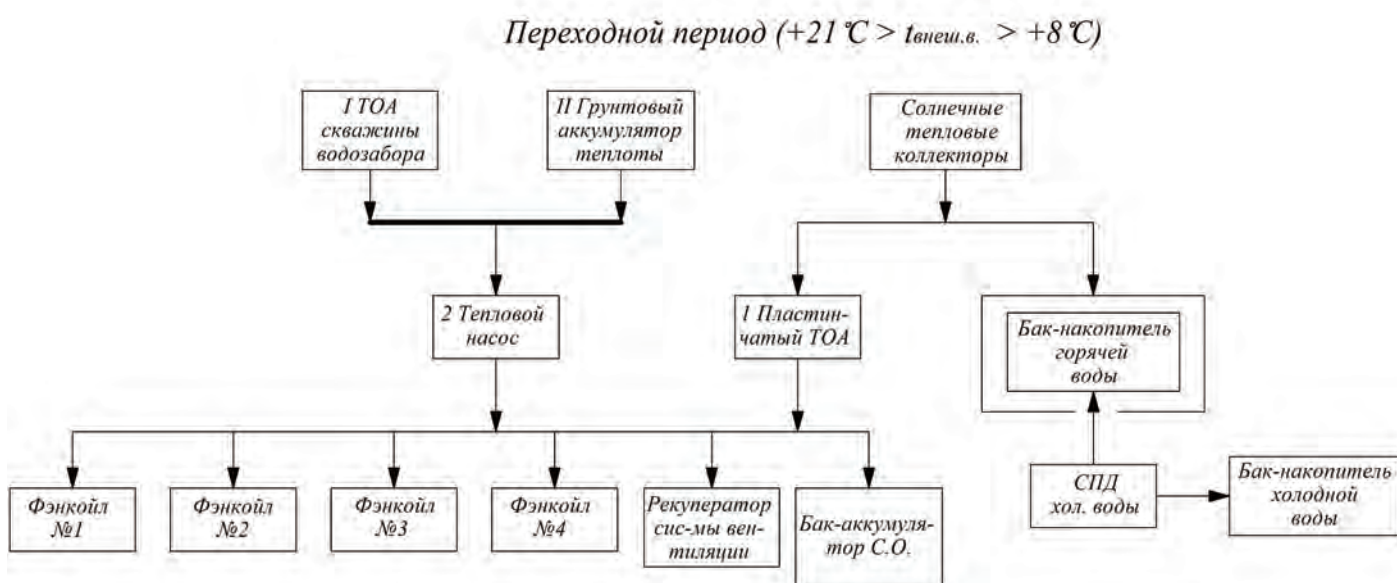
Рис. 3. Работа системы теплоснабжения в переходной период года
