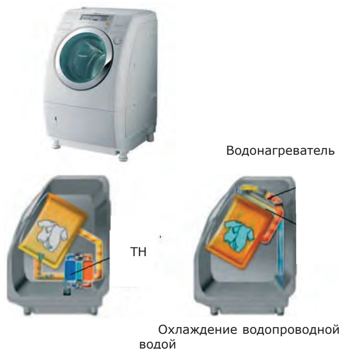
Рисунок 2. Сушильная машина на базе теплового насоса
