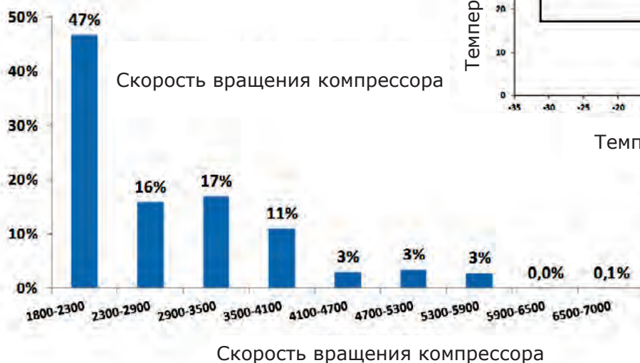
Рисунок 5. Результаты тестирования компрессора с переменной скоростью, в котором в качестве хладагента применяется R410A
