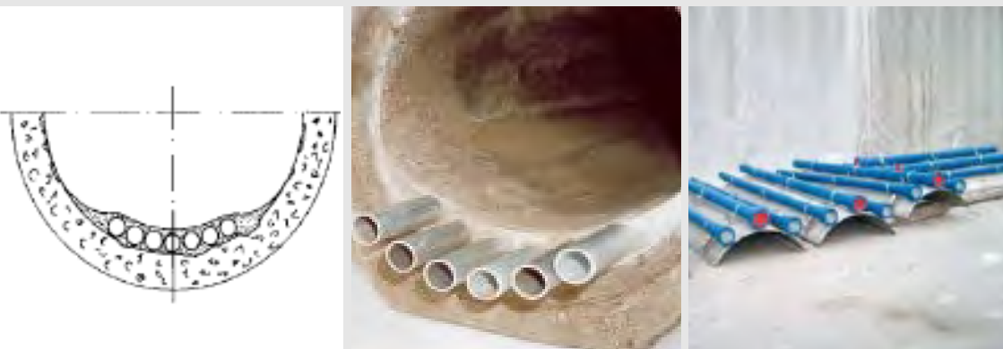
Фото 6. Конструкции теплообменников, размещаемых в канализационных коллекторах
