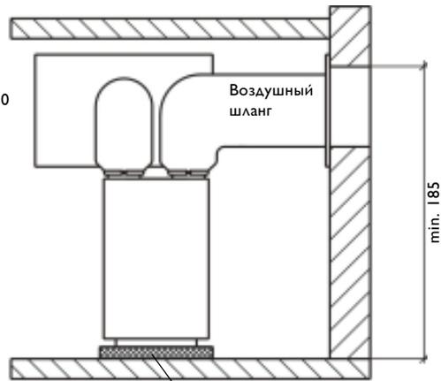
Бетонный фундамент для установки теплового насоса **WPL 10 KW**
