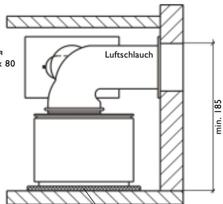
Бетонный фундамент для установки теплового насоса **WPL 15/20 KW**
