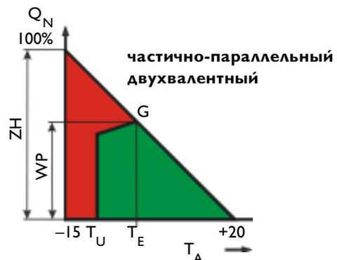
Система распределения тепла  $t^{\circ} < 60^{\circ}\text{C}$
