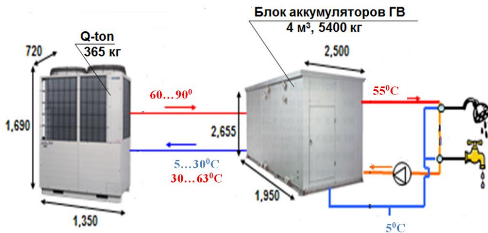
Илл. 3.5 – Структура ТНУ на основе теплового насоса «воздух-вода» модели Q-ton ESA30, заправленного рабочим агентом R744 (см. раздел 2)
