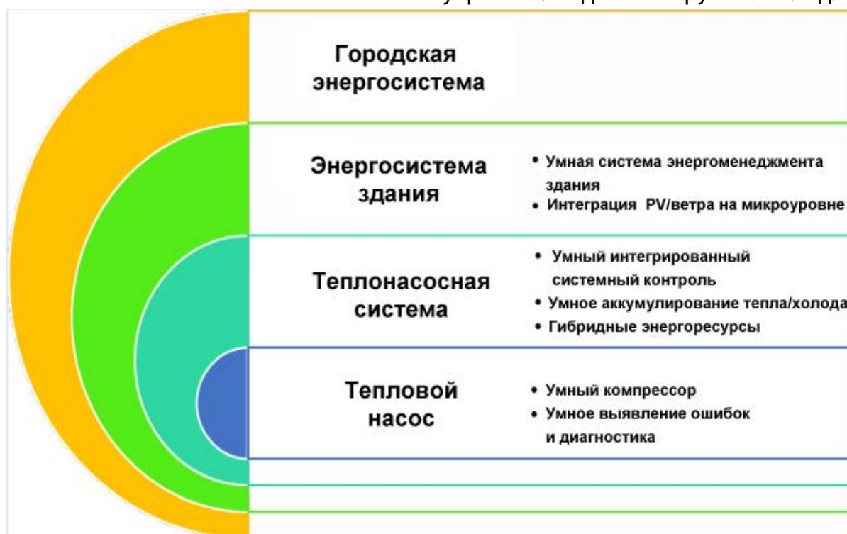
Рисунок 1. Система интеллектуального теплового насоса просматривается с четырех разных уровней в зависимости от того, где проведена граница системы.
