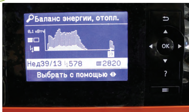
Понедельный баланс энергии теплового насоса (затраченная электрическая энергия и выработанная тепловая энергия)
