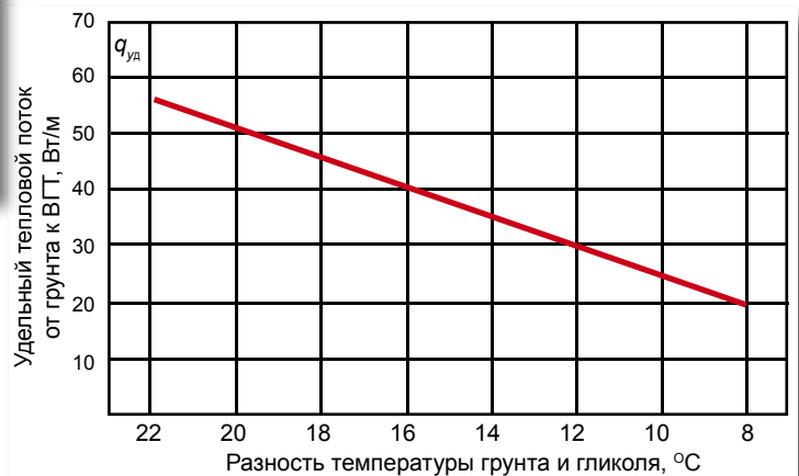
Рисунок 6. Характеристика изменения величины удельного теплового потока к ВГТ от разности температур грунта в естественном его состоянии и гликоля
