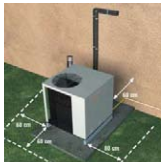
Наружный теплохолодильный блок на основании с минимальными расстояниями и необходимым свободным пространством
