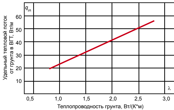
Рисунок 3. Характер изменения величины удельного теплового потока к ВГТ от грунтов с различной теплопроводностью
