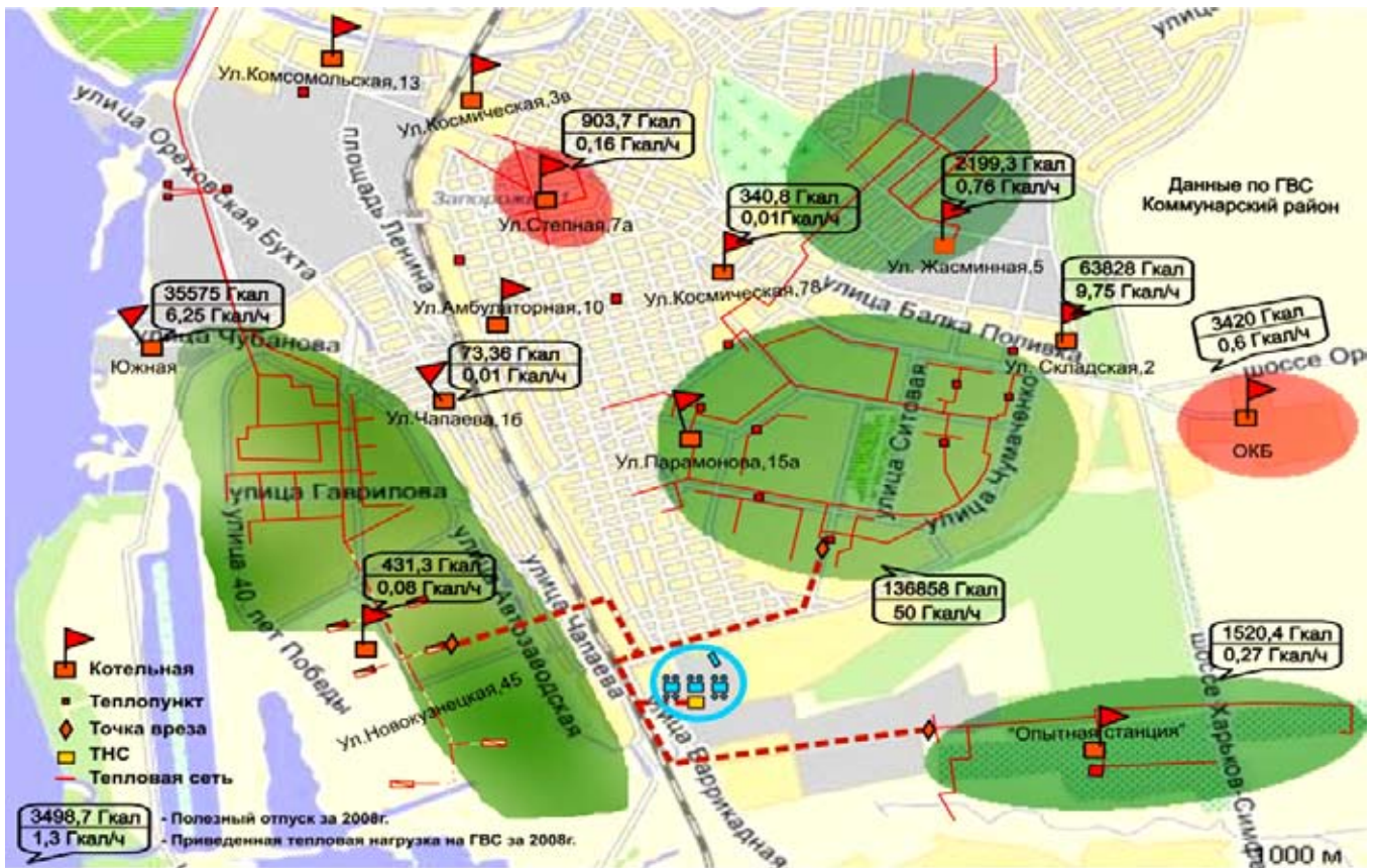
Рисунок 4. Схема тепловых участков системы ГВС Коммунарского района Запорожья на базе ТНС на сточных водах
