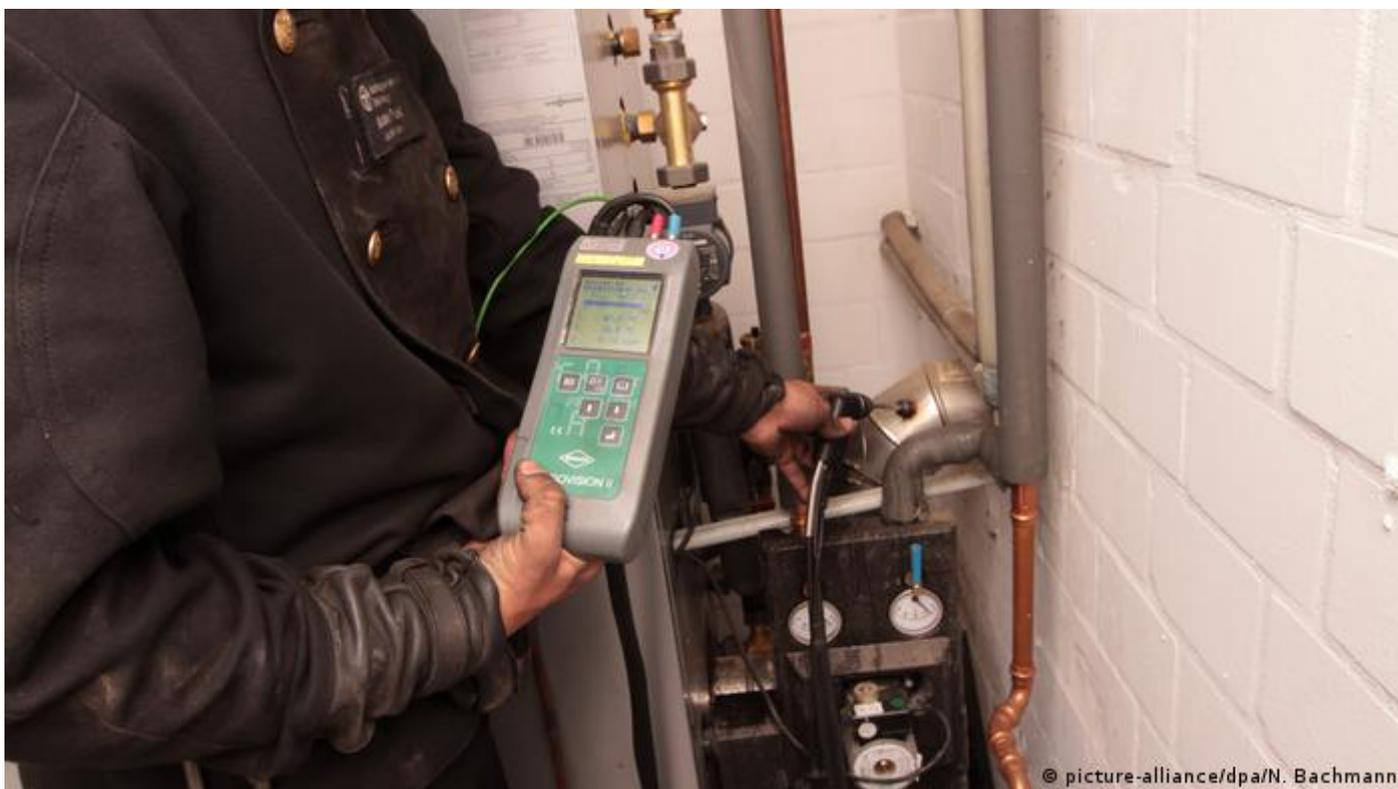
Так измеряют эмиссию CO<sub>2</sub> дизельного котла
