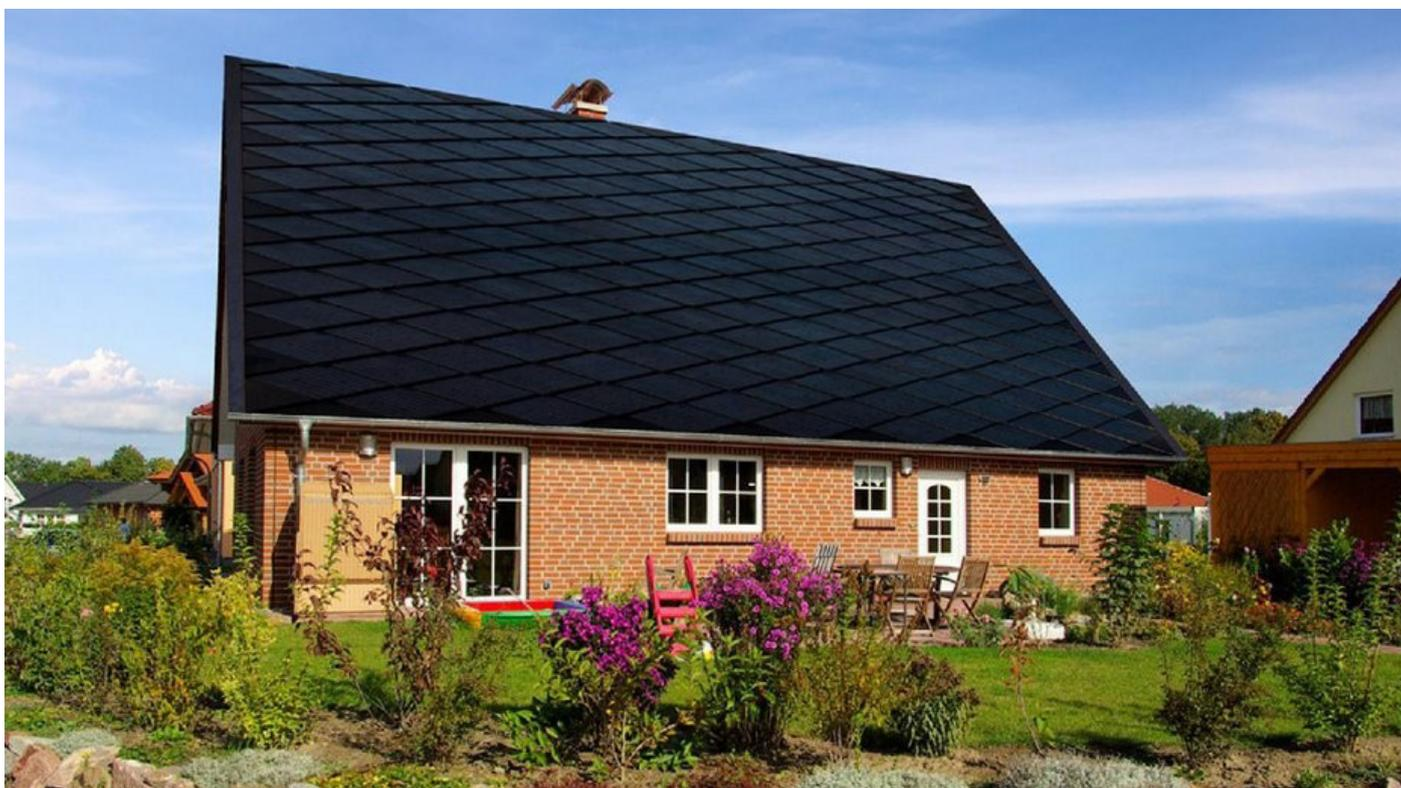
*Заявленные технические характеристики кровельных модулей SolteQ Quad40 (премиальный сегмент): масса – 14 кг на 1 м<sup>2</sup>; материал фотоэлементов – монокристаллический кремний; размер модуля – 540x540 мм; производительность – от 173 до 208 Вт на 1 м<sup>2</sup>; эффективность фотоэлементов – 18,8 – 19,8%; номинальное напряжение – 4,7 В; номинальный ток – 8,75 – 9,0 А; срок службы – более 40 лет; гарантия – 5 лет.*
