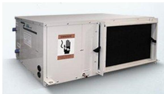
Отличный промышленный образец теплового насоса, который при потреблении 2,6 кВт энергии производит 11,7 при подогреве, и 9,2 кВт энергии — при охлаждении. Есть фреоновый контур, роторный компрессор, блок контрольного щита из панели ввода, реле и трансформатора. Теплый воздух может нагнетаться двумя способами — боковым или прямым. Потребители отмечают экономичность и энергоэффективность прибора, который работает на фреоне, устойчивость к внешним воздействиям и очень низкий уровень шума.
